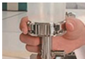
(A) 特殊密封不测漏,将交叉污染降至极低,无需火焰
