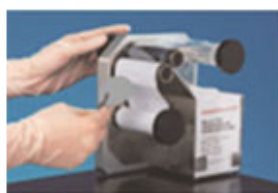
(B) 采用 MBS1 取膜器,快速分配一张无菌滤膜
