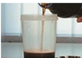
(C) 操作灵活,滤杯体积 350ml 或 100ml 漏斗可反复灭菌
